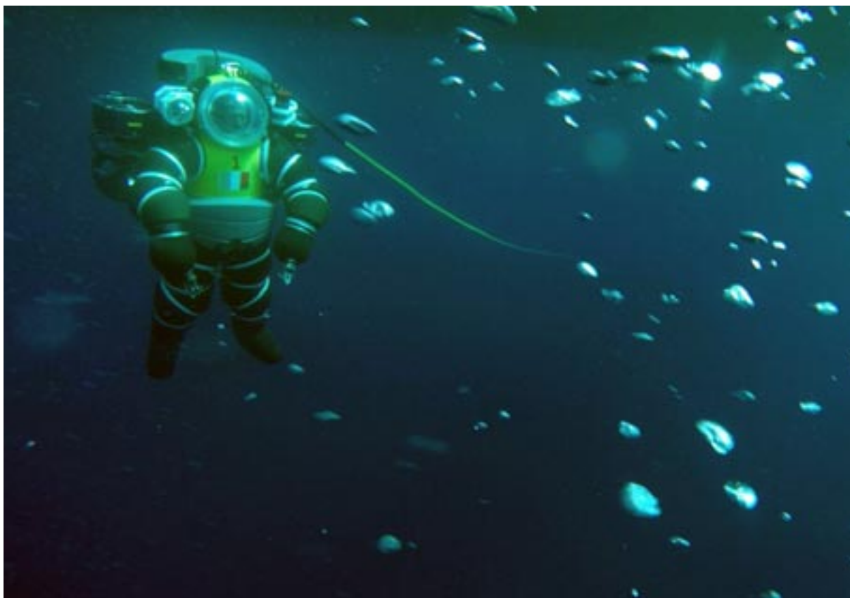
Figura 2 - Palombaro della Marina Militare durante l'avvicinamento al sito di lavoro con Atmospheric Diving System (ADS).
