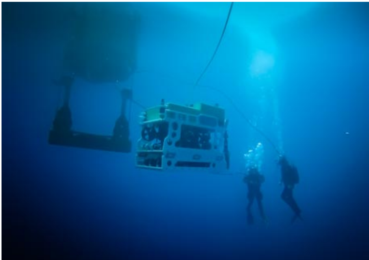
Figura 3 - Palombari della Marina Militare durante un'attività iperbarica condotta con sistema integrato Remotely Operated Vehicle (ROV) modello Pegaso da nave soccorso Anteo .
